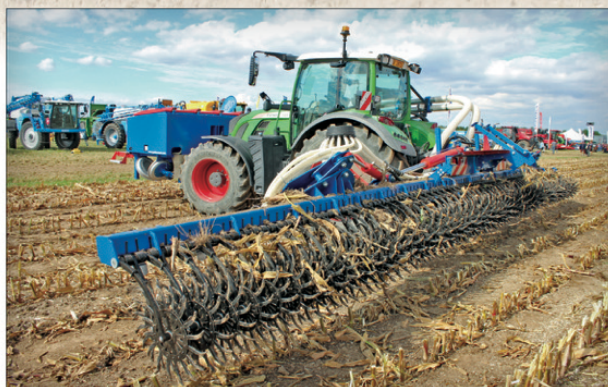
Hnojivo je vedeno před pracovní orgány plečky a pomocí odrazových plechů rozptylováno do celého pracovního záběru
